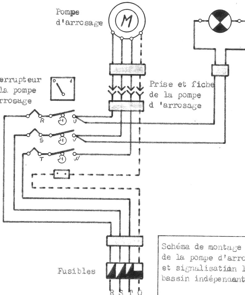
Schéma de montage pour circuit force de la pompe d'arrosage, avec thermique et signalisation lumineuse, avec ou sans bassin indépendant sur table ou socle K
